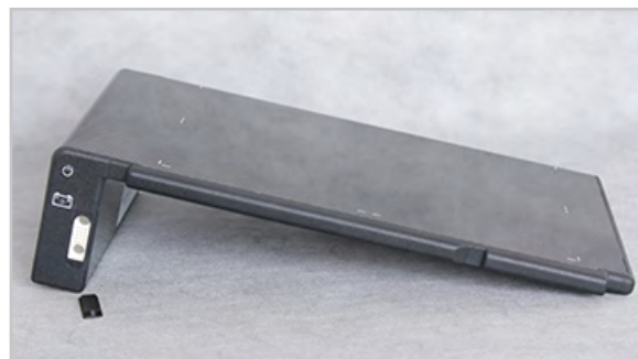
Рис. 2. Внешний вид переносного детектора «СОЛО ДМ-МТ»
